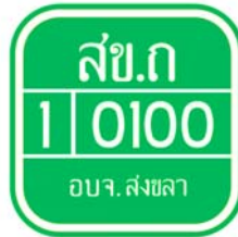
ป้ายหมายเลขทางหลวง ( น1/1 )
